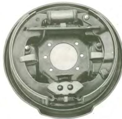
Bremstrommeln aus normalem Guss, um 10 mm vergrössert : Durchmesser : 255 mm
